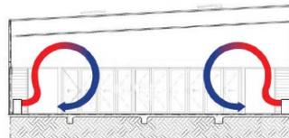
Konvektionswärme kann in nicht isolierten Bereichen verloren gehen und steigt zur Decke.
