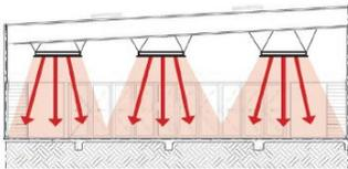
Strahlungswärme verteilt sich direkt nach unten und erwärmt den Raum, der beheizt werden muss.
